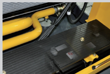
加装电池防护板，防止雨水侵袭，延长使用寿命。
