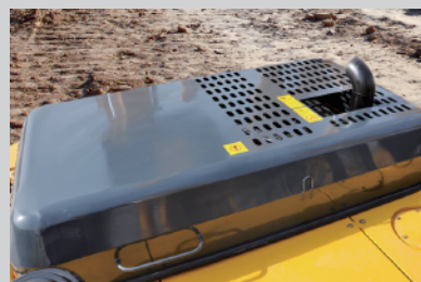
发动机罩整体板块冲压，更美观、坚固耐用，散热效果更佳。
